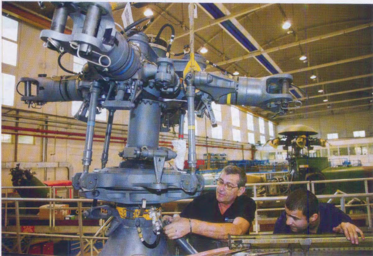
Durant la révision complète d'un hélicoptère, l'appareil est littéralement désossé : les capots sont enlevés, les équipements démontés pièce par pièce, la peinture décapée...
