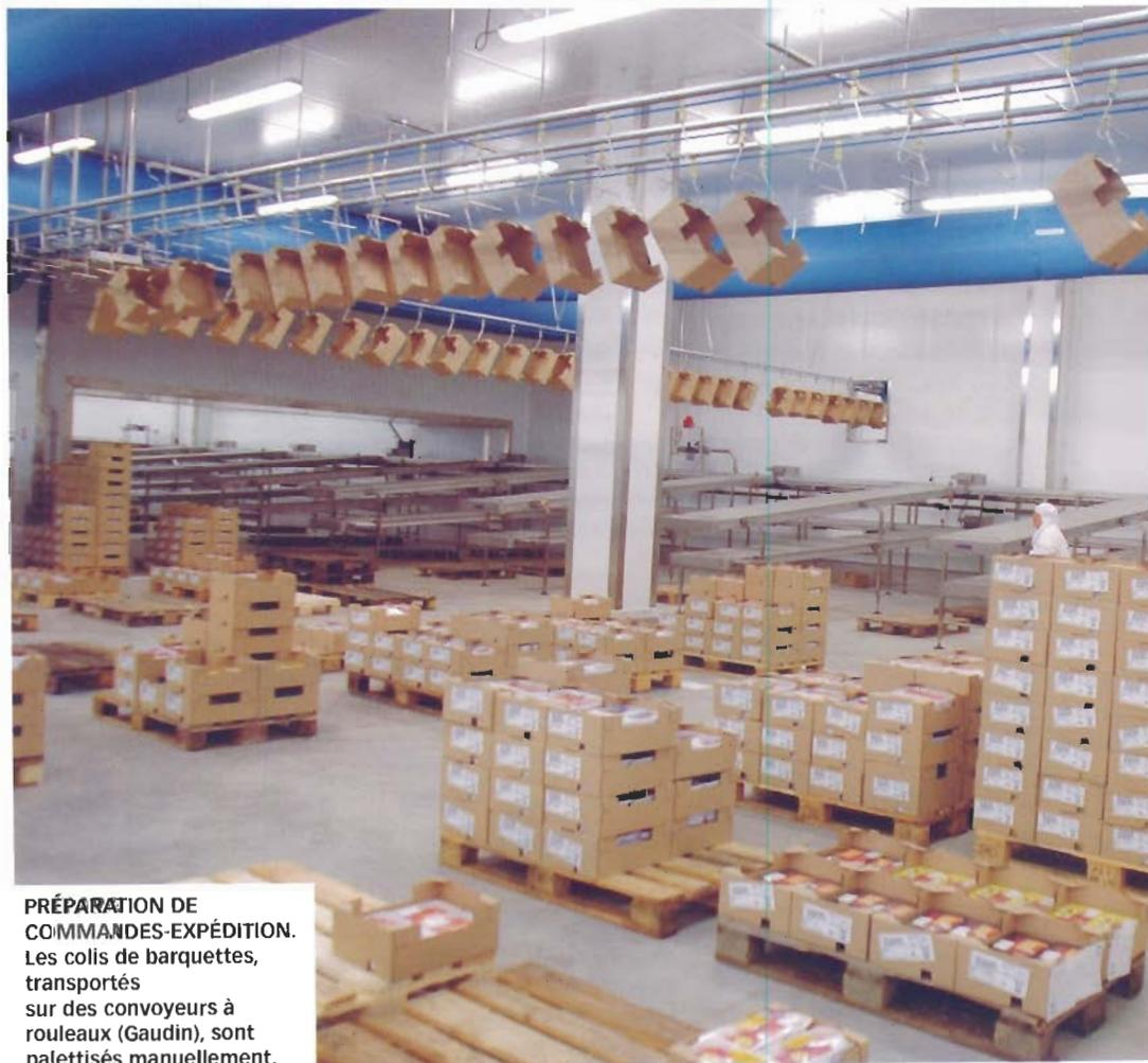
**PRÉPARATION DE COMMANDES-EXPÉDITION. Les colis de barquettes, transportés sur des convoyeurs à rouleaux (Gaudin), sont palettisés manuellement.**
