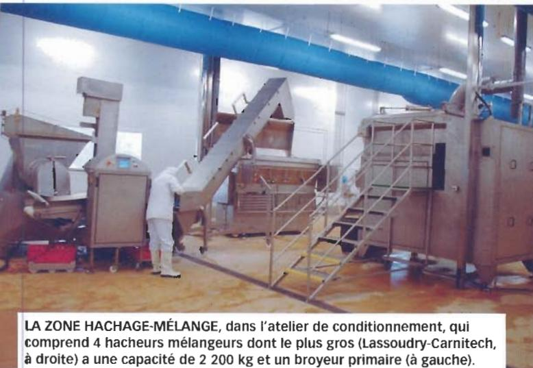
**LA ZONE HACHAGE-MÉLANGE, dans l'atelier de conditionnement, qui comprend 4 hacheurs mélangeurs dont le plus gros (Lassoudry-Carnitech, à droite) a une capacité de 2 200 kg et un broyeur primaire (à gauche).**
