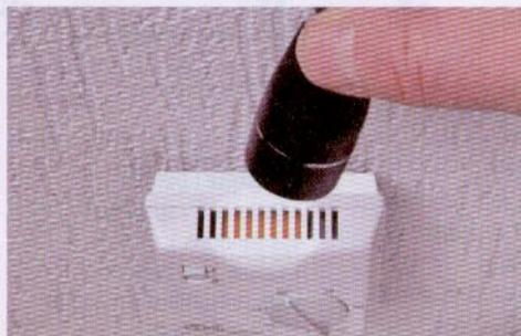
**Contrôle.** Il suffit de vérifier à l'aide d'une torche électrique l'état du composant orange incriminé.
