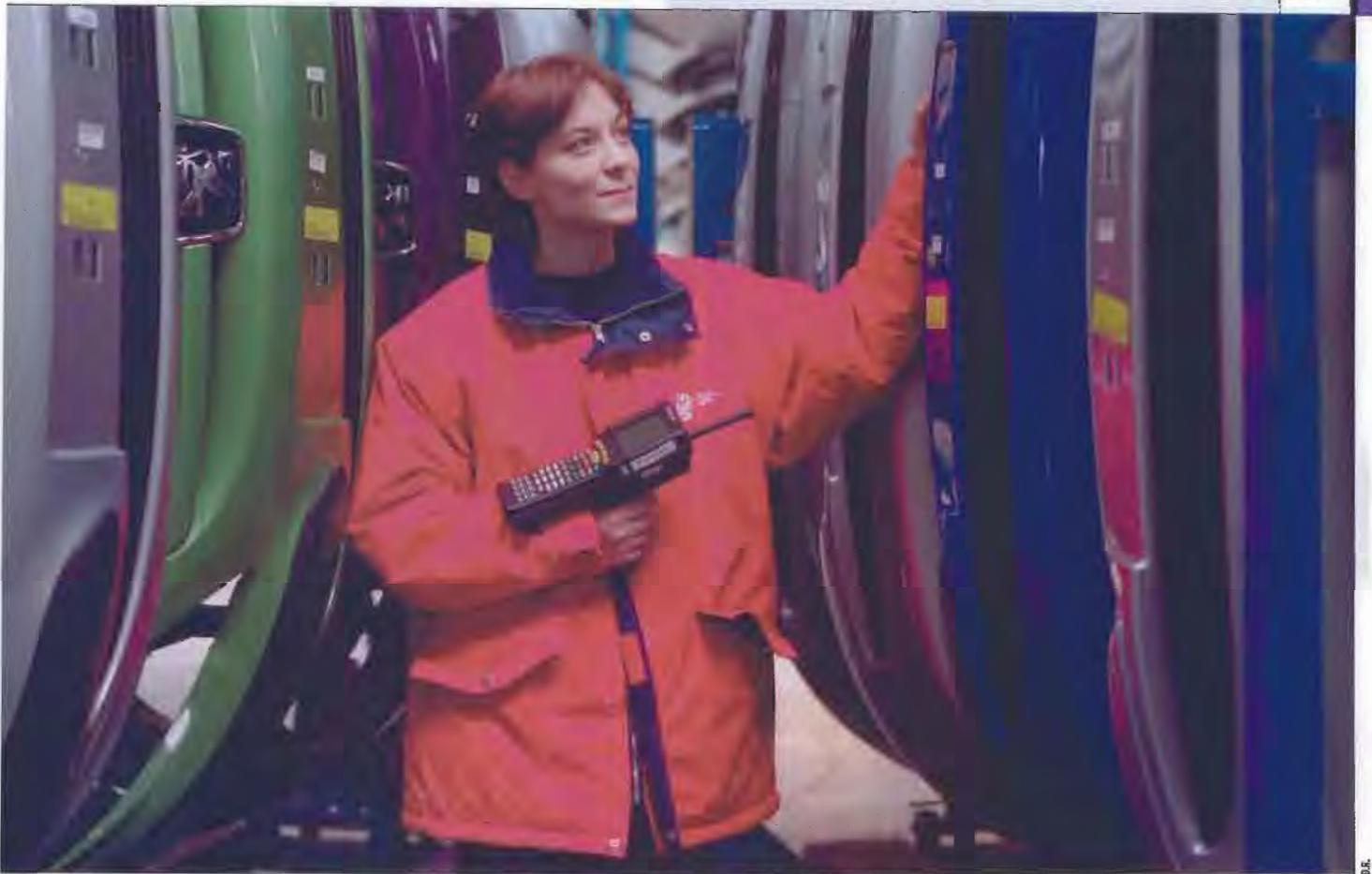
Un rangement prêt-à-monter. Pour s'assurer du bon ordre des sous-ensembles dans les racks à livrer (selon les attentes de la ligne de montage du client) une opératrice procède à des saisies de codes-barres et à un contrôle visuel.
