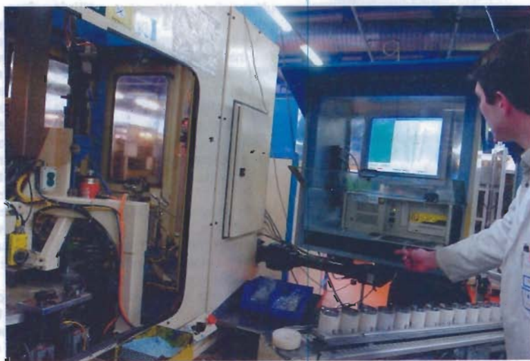
Méthode. Les valves et les pompes sont contrôlées automatiquement, via un logiciel de mesure en temps réel, sur les postes d'assemblage et d'équilibrage en bout de ligne.
