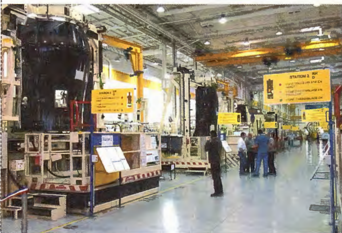
Réactivité. Le système de feux tricolores alerte les équipes de maintenance de la gravité des incidents de production.
